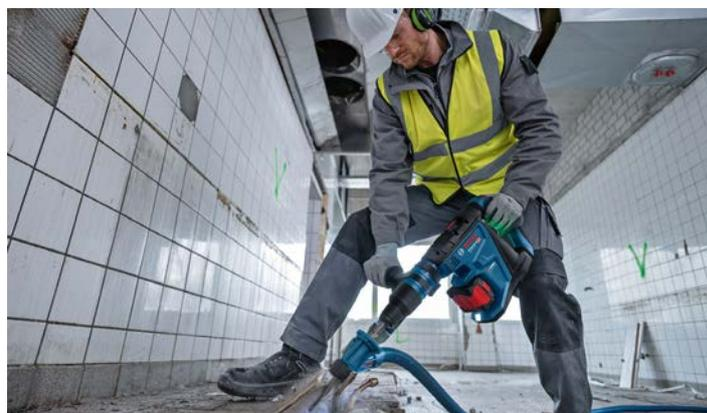
Pour un meilleur confort d'utilisation, **la batterie du perforateur est intégrée à l'avant de l'outil, ce qui optimise son centre de gravité** et le rend plus facile à manier. La poignée déportée permet une manipulation aisée et une réduction des vibrations de l'outil.
