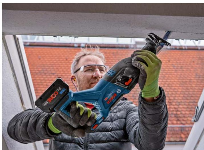
Par ailleurs, lorsque la scie sabre GSA 18V-28 Professional est équipée de la lame à technologie carbure Expert Thick Tough Metal, les artisans peuvent couper rapidement, de manière précise et droite, du métal épais, des tuyaux en fonte, des profilés en acier...
